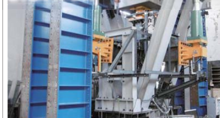
実大試験体（部分骨組架構）の載荷実験の様子
