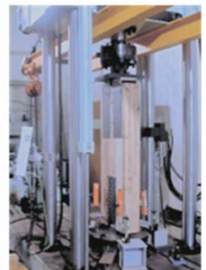
CLT接合部実験
