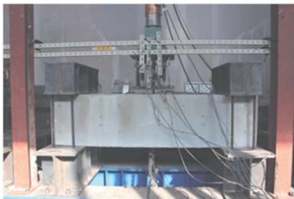
アンカーボルトの引き抜き実験 研究紹介の例
