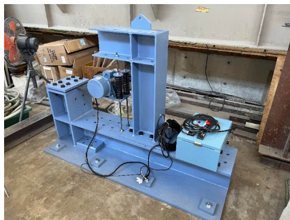
写真-4 振動疲労試験機
